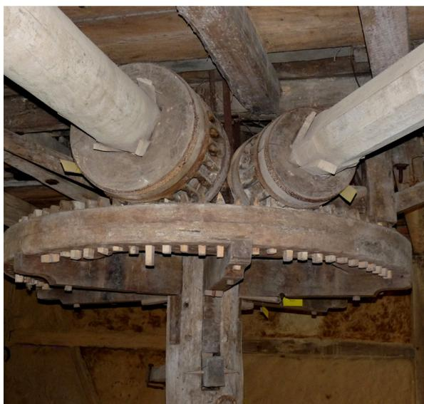
Datant probablement du XVIII<sup>e</sup> siècle, citée en 1849, l'huilerie à manège a fonctionné jusqu'à la fin des années 1930. La force motrice d'un cheval y faisait tourner une meule verticale sur une table circulaire en pierre, en forme de cuvette, dite conche ou auge. On y écrasait différents oléagineux tels que pavot, chènevis, colza, tournesol, noix.
